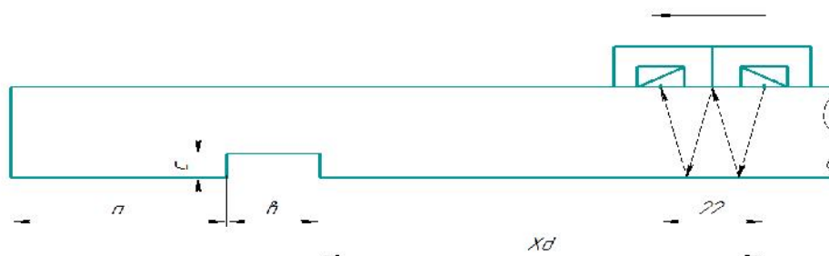
Рисунок 13. Совмещенные наклонные датчики (зеркально – теневой метод) расположены над основным металлом
