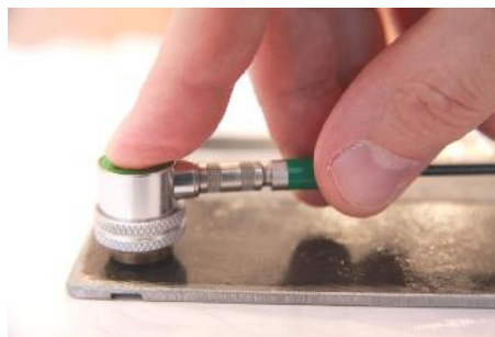
Рисунок 2. Прямой совмещенный преобразователь на образце металлической пластины с дефектом типа «пропил»
