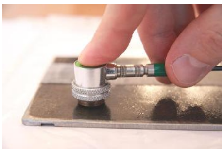
Рисунок 2. Прямой совмещенный преобразователь на образце металлической пластины с дефектом типа «пропил»
